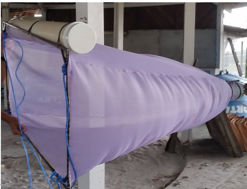
Figura 41. Exemplo de um coletor de zooplâncton.
