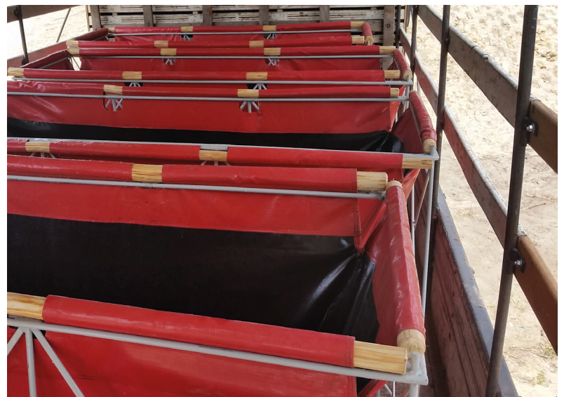
Figura 19. Disposição dos tanques de transporte para matrizes de pirarucu no caminhão.
