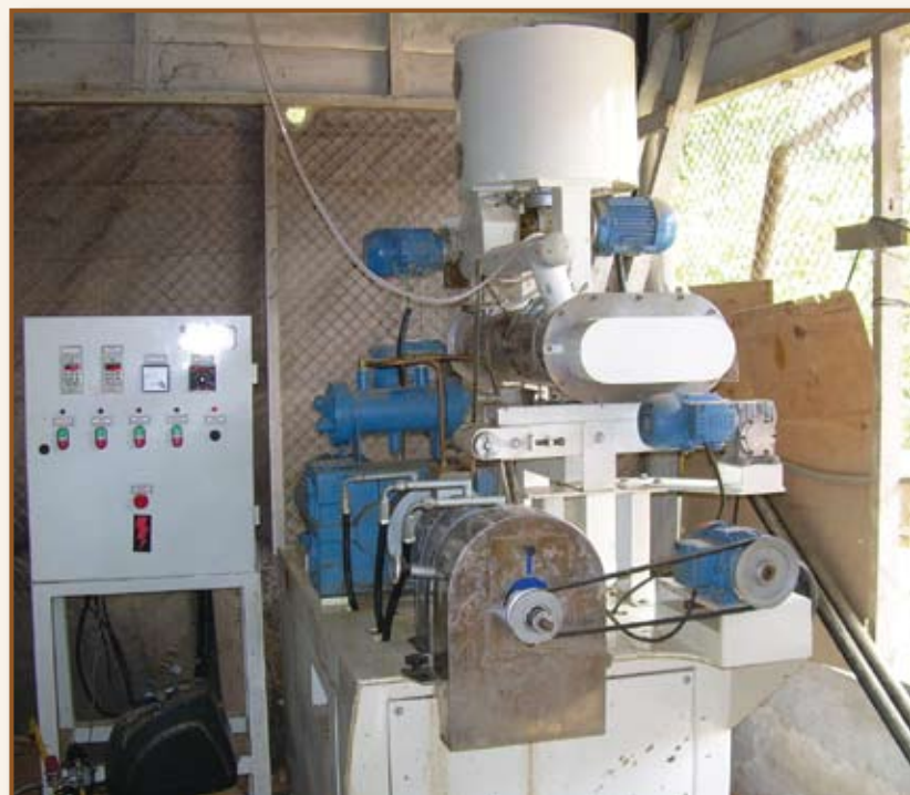
Foto 1: Extrusora utilizada para a confecção de rações experimentais para estudos de nutrição com o pirarucu no INPA/CPAQ (Foto: Eduardo Ono)
