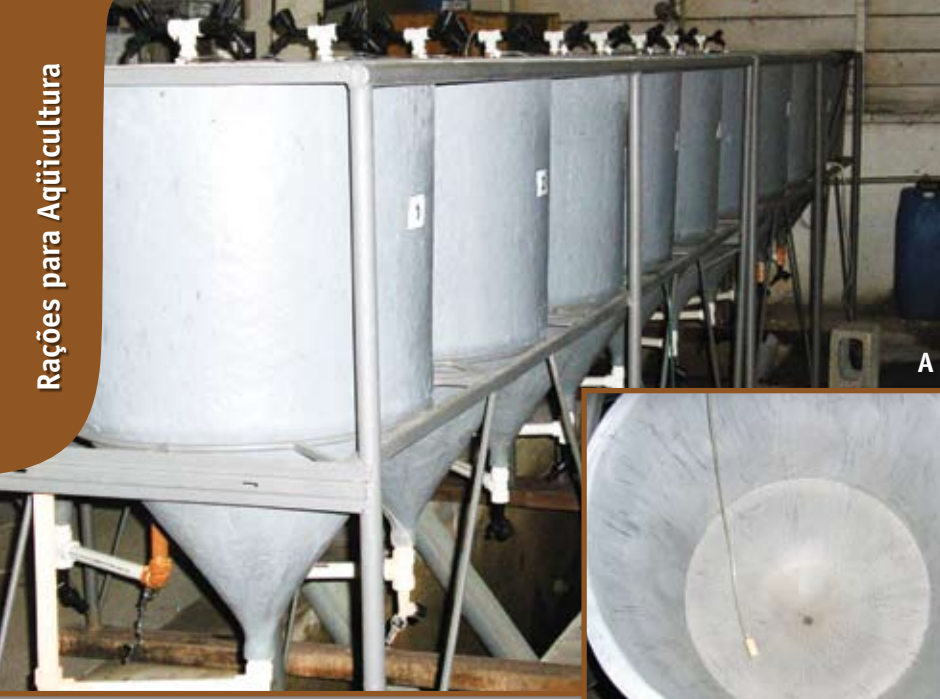
Fotos 3A e 3B: Tanques circulares auto-limpantes utilizados em experimentos realizados com o pirarucu no INPA/CPAQ (Foto: Eduardo Ono)
